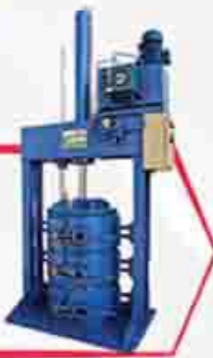
پرس تخلیه پشمک معمولی مواد آرایشی و بهداشتی پلاستیک، بتونه گرس، غیر گرس
